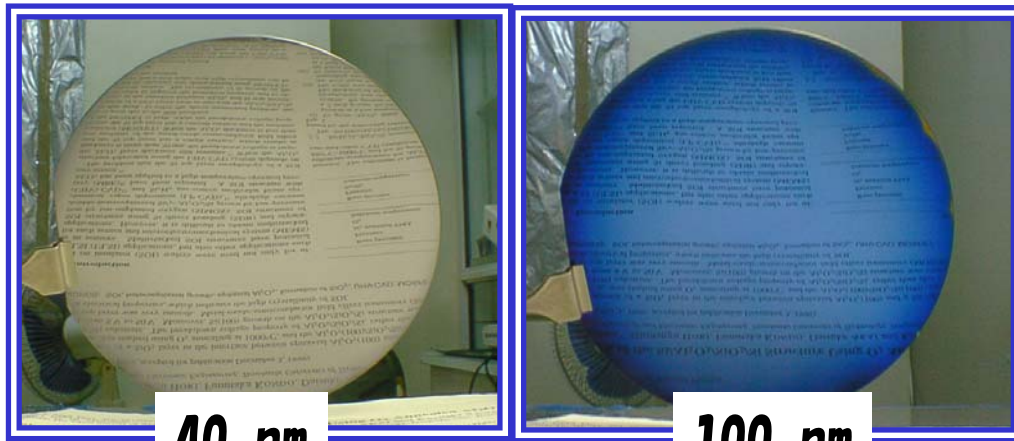
エピタキシャル \gamma\text{-Al}_2\text{O}_3/\text{Si} 基板（知能性基板）
