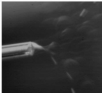
ガラスキャピラリーノズルを用いた静電界による油中液滴生成
