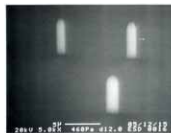
高アスペクト比をもつ ダイヤモンドマイクロ構造体 (直径: 1 \mu\text{m} , 高さ: 4 \mu\text{m} )
